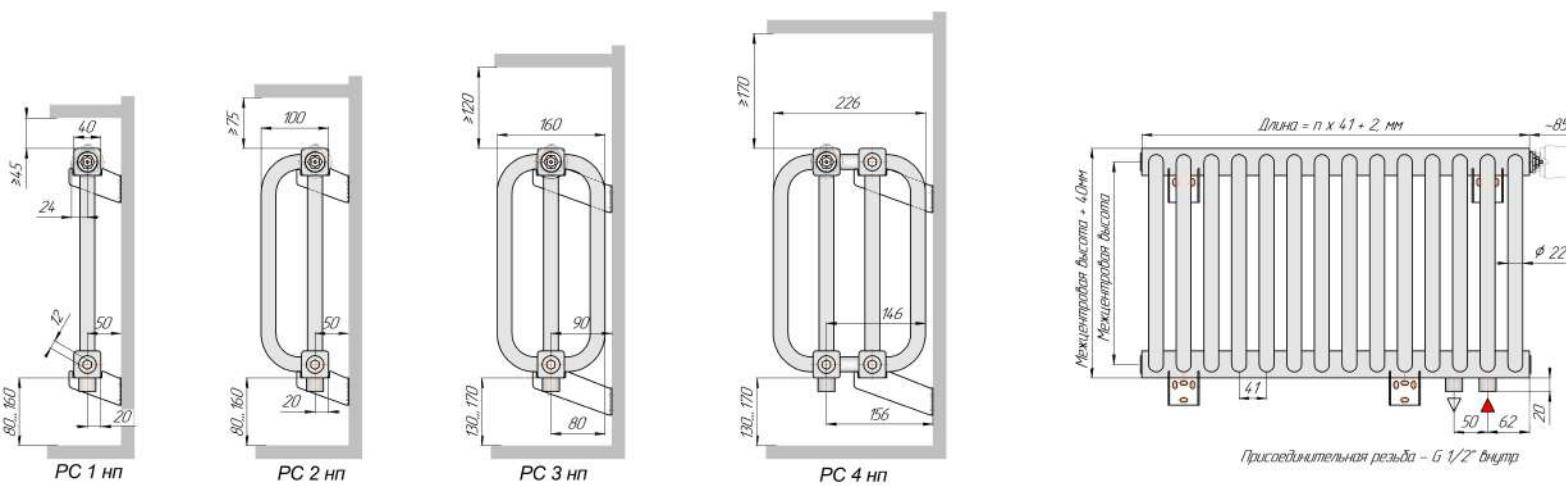
**Радиаторы с нижним подключением "PC нп нв", монтажные схемы
